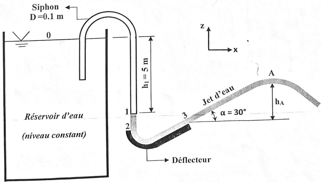
1. Ecrire l'équation de Bernoulli entre les points (0) et (1), puis déterminer le débit massique de l'écoulement dans le siphon.
